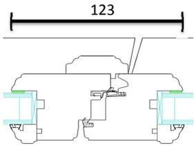
Recouvrement + double joint = protection acoustique
