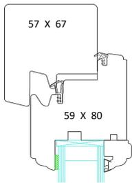
Bâti avec aile de recouvrement
