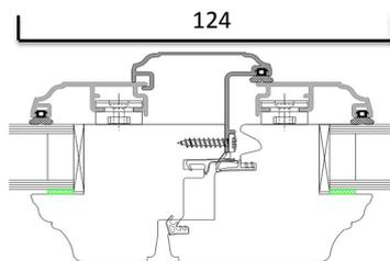
Recouvrement + triple joint = protection acoustique
