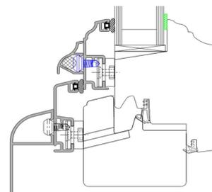
L'intercalaire isolant "warm edge" empêche la chaleur de traverser la barrière de scellement du double vitrage
